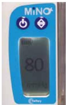
**Logica di funzionamento chiara e semplice:** Una tastiera a membrana antisporco dà accesso a tutte le funzioni del sistema, con solo 2 pulsanti. Il display LCD con illuminazione temporizzata mostra icone grafiche per indicare la depressione impostata e lo stato di carica della batteria.
