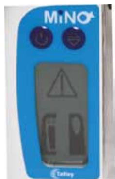
**Sistema autodiagnostico avanzato:** Venturi Mino™ dispone di un sistema di autodiagnistica con allarmi acustici e grafici per le condizioni di serbatoio pieno o assente, perdita nella medicazione, scollegamento, strozzamento od occlusione del tubo, ed inclinazione eccessiva. Gli allarmi si autocancellano una volta eliminata la causa che li ha generati.
